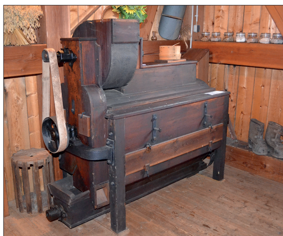
Fig. 20. A Schälmaschine (shelling machine) in Sohland Mühle (G. Hackney).
